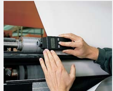
testo 470, medición mecánica de rpm, por ejemplo, en un rodillo
