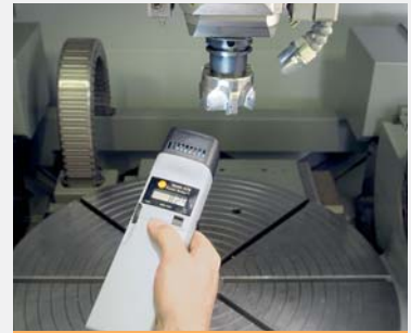
testo 476 Pocket Strobe, imagen fija de piezas en movimiento a altas frecuencias
