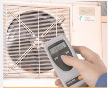
testo 465, medición de rpm en ventiladores
