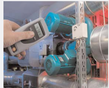
testo 470, medición de rpm en partes rotativas sin contacto
